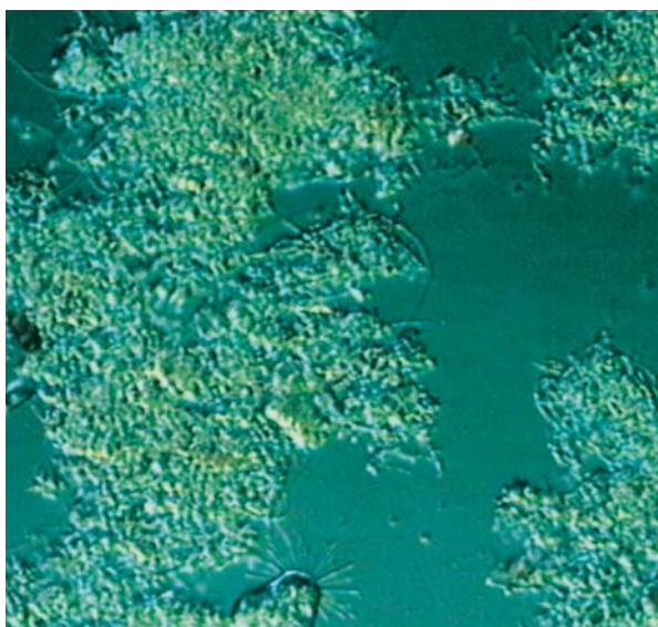
Flóculo fuerte y bien constituido después de 15 días con oxígeno puro.
