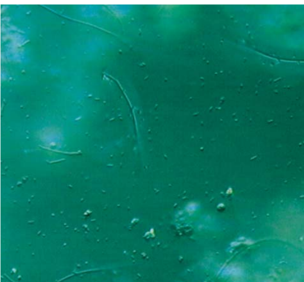
Flóculo débil por carencia de oxígeno de una depuradora de industria cervecera.
