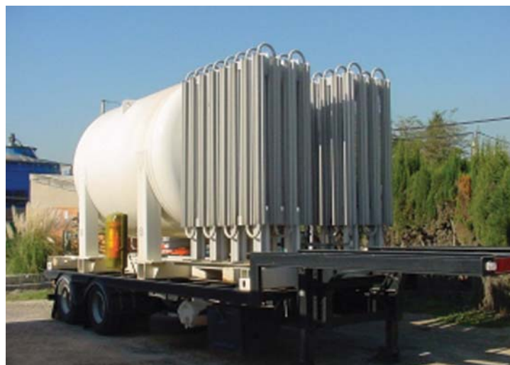
Cisterna móvil para situaciones de emergencia
